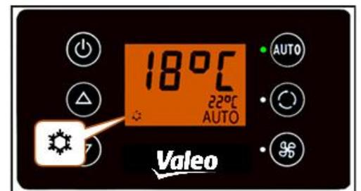
Abbildung 7 - SC600 Automodus aktiviert, Kühlbetrieb
