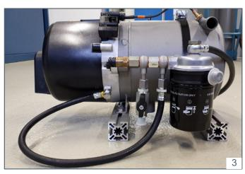
4. Монтаж топливного шланга на подогреватель (16 Hm) с новыми кольцевыми уплотнениями 10 мм.
