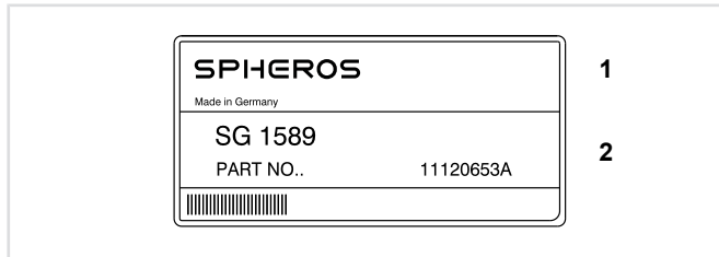
Abb. 4: Typenschild Steuergerät Beispiel Thermo plus
