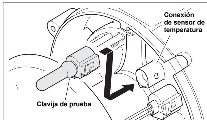
Imagen 19: clavija de prueba (11117924A) en calefactores a partir de 12/2012
