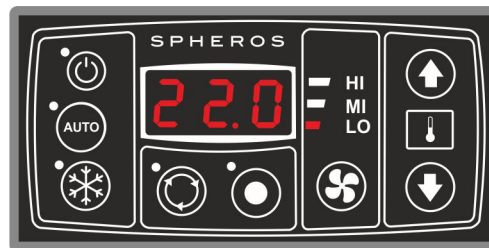
Fig. 14: SC410 Low fan speed level
