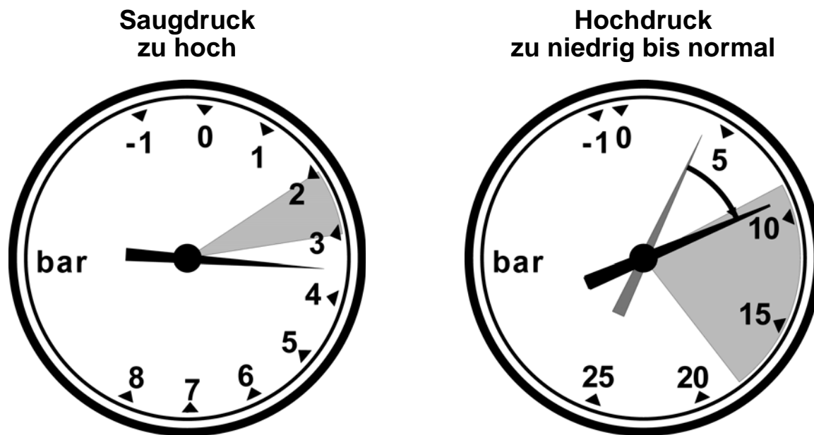
Bild 8-7. Saugdruck zu hoch, Hochdruck zu niedrig bis normal
