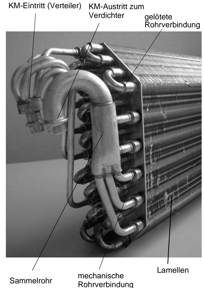
Bild 4-34. Lamellenverdampfer
