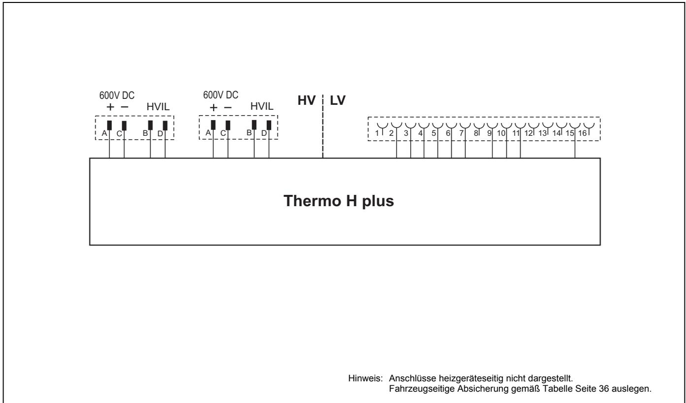
**Bild 9:** Anschlussplan Steuerkopf DC/DC der Thermo H plus (exemplarisch, andere Konfigurationen möglich),
