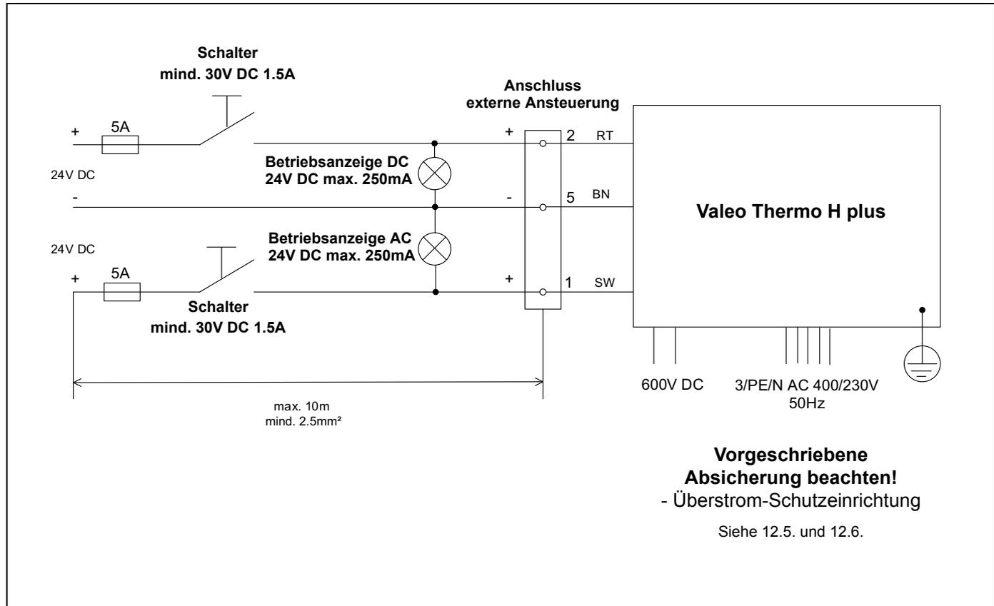
Bild 14: Steuerung des elektrisch betriebenen Teils des Heizgerätes mit Schalter (Relais)
