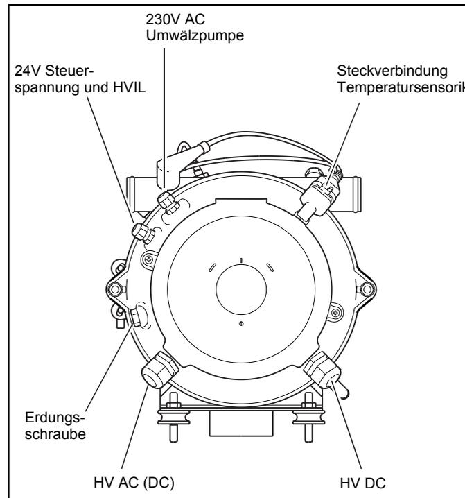
**Bild 8: Anschlüsse und Kabeldurchführungen (exemplarisch, andere Konfigurationen möglich)**
