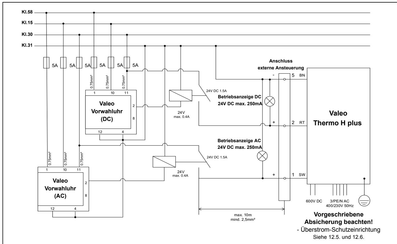
**Bild 15: Steuerung des elektrisch betriebenen Teils des Heizgerätes mit Vorwahluhr**
