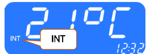
Abbildung 10 - SC1000 Raumtemperatur anzeigen lassen
