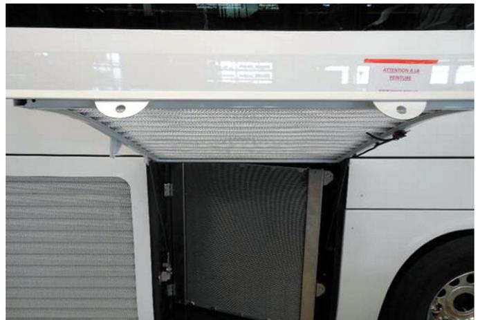
2. Verflüssiger herausschwenken durch Entfernen der Schrauben Sw13.
