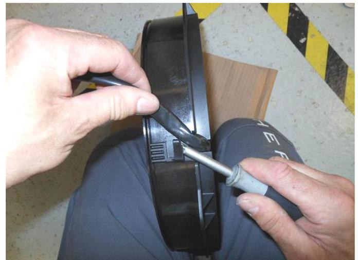
5. Neue Lüfter montieren, das Anschlusskabel zeigt nach unten. Schrauben mit 5Nm anziehen.
