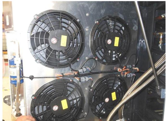
3. Entfernen der Kabelbinder und Ausbau der alten Lüfter mit geeignetem Torx-Werkzeug.
