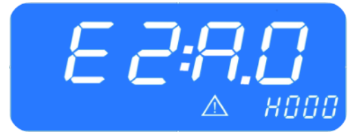
Abbildung 28 - SC1000 Fehler nicht behoben
