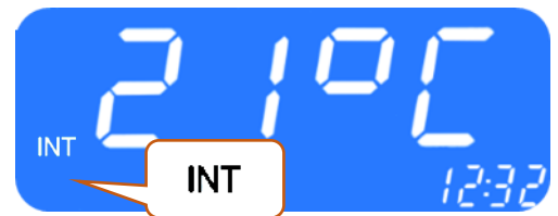
Abbildung 12 - SC1000 Aktuelle Raumtemperatur
