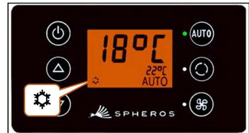
Abbildung 6 - SC600 Automodus aktiviert, Kühlbetrieb
