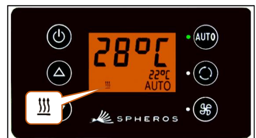
Abbildung 8 - SC600 Automodus aktiviert, Heizbetrieb
