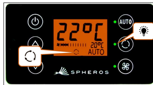
Ilustração 9 - SC600 função de circulação de ar ativado
