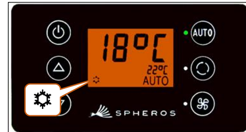
Ilustração 5 - SC600 modo automático ativado, refrigeração
