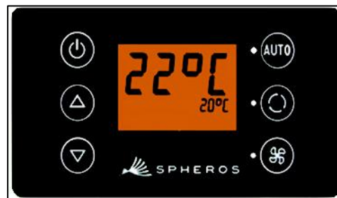
Ilustração 7 - SC600 modo automático desativado
