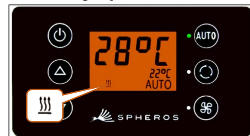
Ilustração 5 - SC600 modo automático ativado, refrigeração
