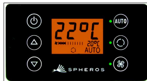
Ilustração 14 - SC600 indicação normal de funcionamento
