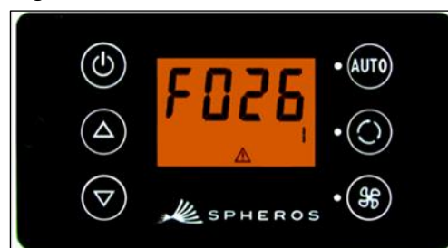
Ilustração 13 - SC600 leitura do código de falha
