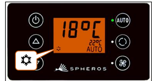
Abbildung 6 - SC600 Automodus aktiviert, Kühlbetrieb
