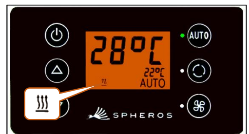
Abbildung 7 - SC600 Automodus aktiviert, Heizbetrieb
