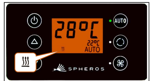
Abbildung 8 - SC600 Automodus aktiviert, Heizbetrieb
