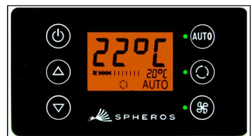
Abbildung 14 - SC600 Normale Betriebsanzeige
