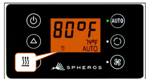
Abbildung 5 - SC600 Automodus aktiviert, Heizung eingeschaltet
