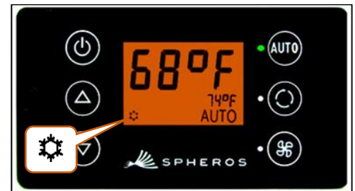
Abbildung 4 - SC600 Automodus aktiviert, Kompressor eingeschaltet
