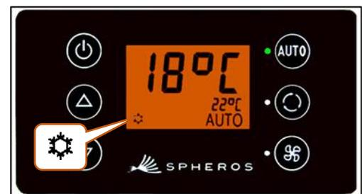
Abbildung 7 - SC600 Automodus aktiviert, Kühlbetrieb
