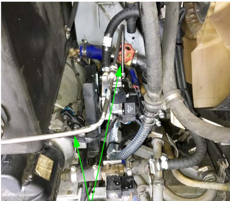
Rohr 500mm des Lieferumfanges muss nach Bedarf entsprechend gebogen und gekürzt werden, um eine Verbindung zwischen der Gasleitung des Fahrzeuges und dem Gasregler herzustellen.
