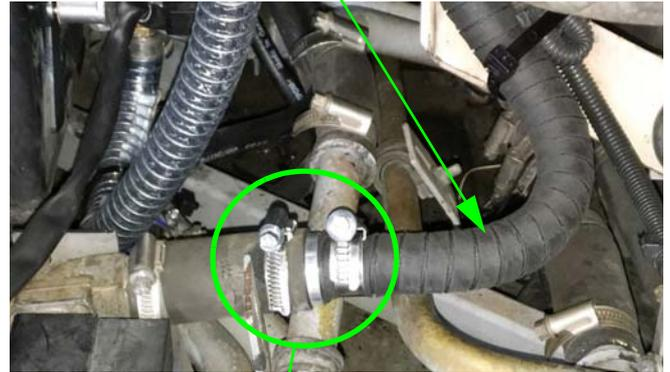
Befestigung mittels Schlauchschellen
