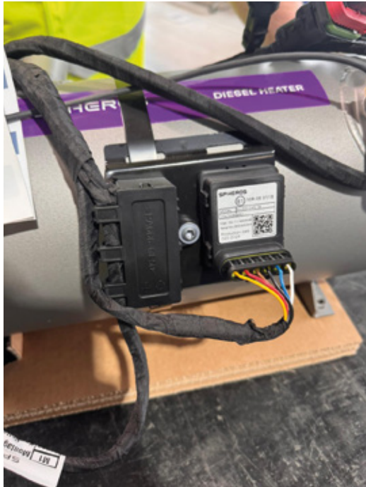
Heizgerät mit sichtbarem Gateway-Modul.
