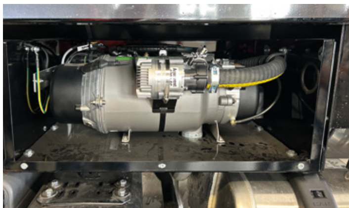
Herzstück ist der hybride Heizansatz des Thermo H Plus, der sowohl elektrisch als auch dieselbetrieben arbeiten kann.
