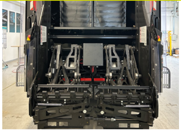
Das Fahrzeug reinigt verschmutzte Mülltonnen direkt beim Entleeren mit heißem Wasser.
