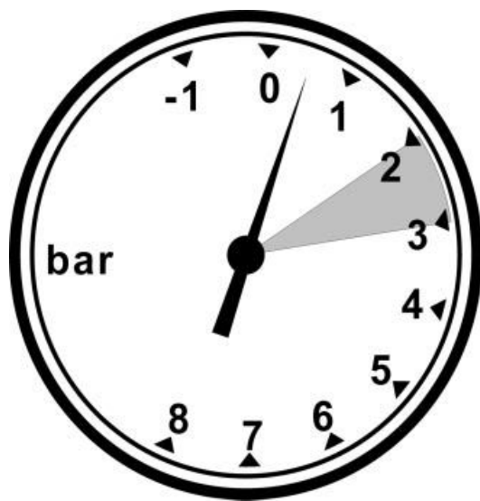
Fig. 8-5. Pression d'aspiration trop basse, haute pression trop basse à normale
