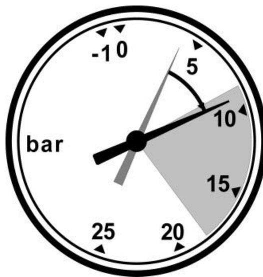
Fig. 8-5. Pression d'aspiration trop basse, haute pression trop basse à normale
