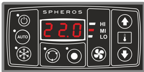
Fig. 12: SC410 Medium fan speed level
