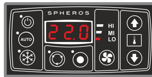
Bild 14: SC410 Gebläse auf langsamer Geschwindigkeit
